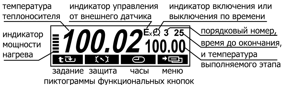
Рисунок 5 — Дисплей в режиме регулирования по программе
